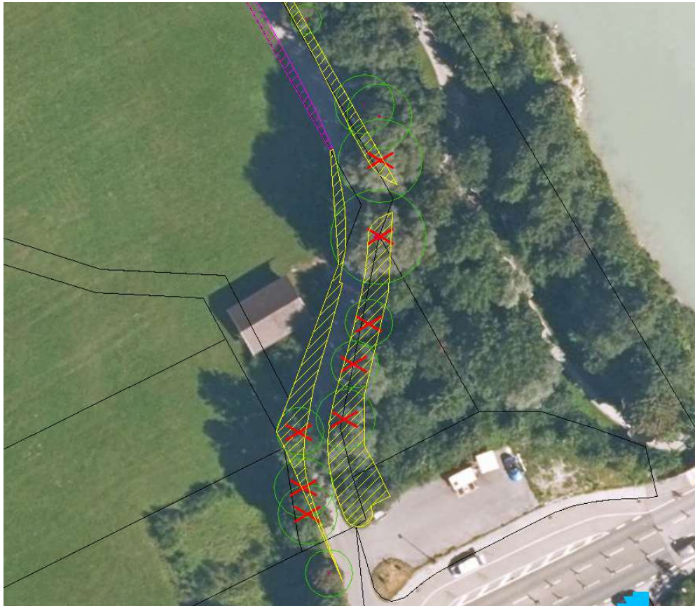
Abb. 23 Baumbestand der für die Errichtung der Zufahrt entfällt (rote Kreuze)
