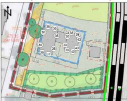
Abbildung: Gesamtes erforderliches Schalldämm-Maß R'ges (maximaler Wert je Fassadenabschnitt)
