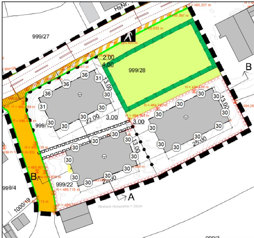
Anlage 4.1: Gesamtes bewertetes Bau-Schalldämm-Maß  $R'_{w,ges}$  Bauvorhaben Erdgeschoss
