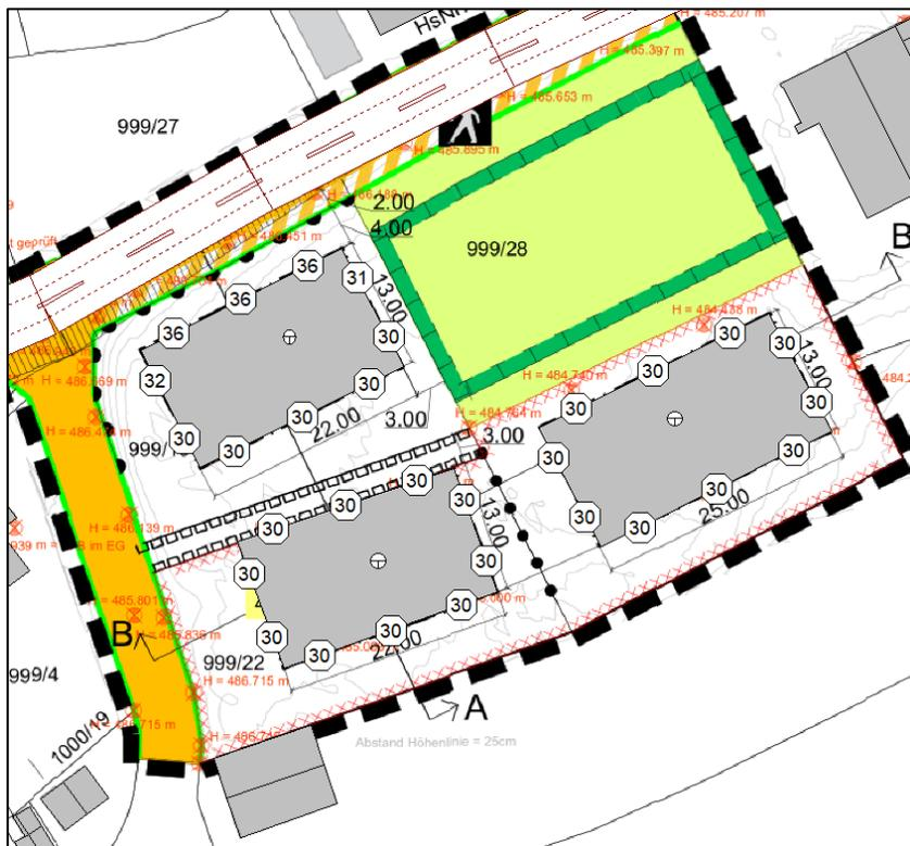
Anlage 4.2: Gesamtes bewertetes Bau-Schalldämm-Maß  $R'_{w,ges}$  Bauvorhaben 1. Obergeschoss
