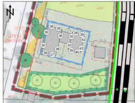
Abbildung: Gesamtes erforderliches Schalldämm-Maß R ges (maximaler Wert je Fassadenschnitt)
